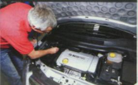
Der 1,6-Liter-Benziner wurde für den Erdgas-Einsatz überarbeitet, dort hinten liegt der Druckregler für das Gas
